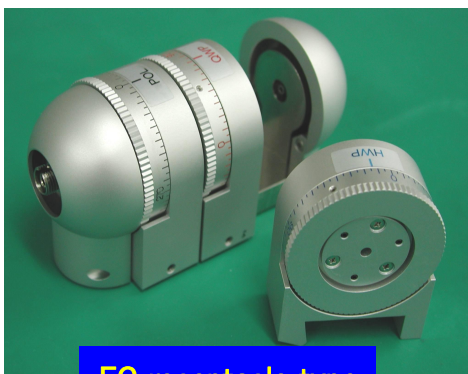
FC receptacle type PCMB15-S/F
