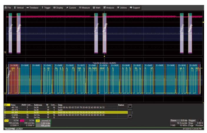
デコードされたプロトコル情報を物理層波形の上に表示したり、プロトコル固有のメッセージでトリガできます。
