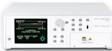
タッチスクリーン: チューニングレンジ、波長スワイプ速度、スワイプモード、出力パワー等のレーザーパラメータを視覚的に設定・モニタできます。操作ボタン: レーザーパラメータやオプションの設定は全て、タッチスクリーンのかわりにボタンでも操作できます。ファイバ出力: FC/APCファイバ出力コネクタです。
