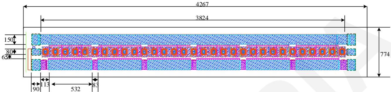
Overall die size 4267 x 774 (+0/-50) microns, die thickness 100 (+/- 10) microns.
